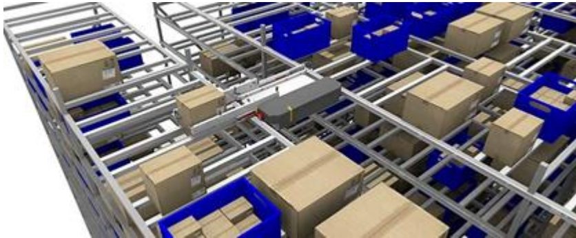
MAG. AUTOMATICO MULTI-SHUTTLE PER COLLI CON BAIE DI PICKING GOODS-TO-MAN
