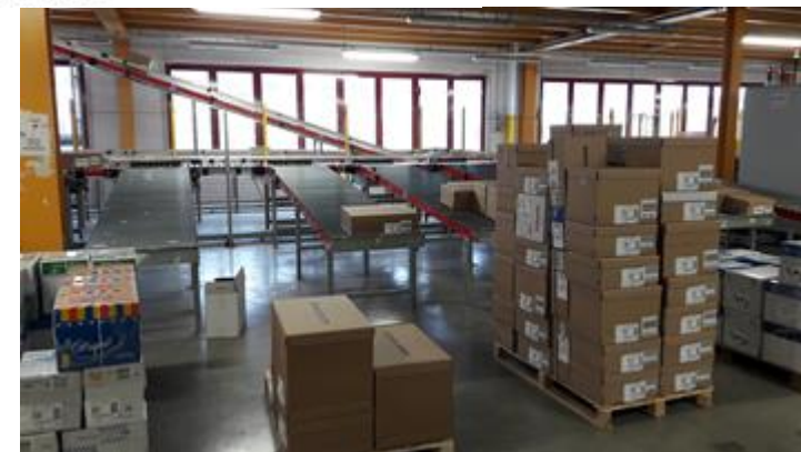
FINE LINEA PER LA CHIUSURA AUTOMATICA DEI COLLI E SMISTAMENTO PER PALLETTIZZAZIONE MANUALE
